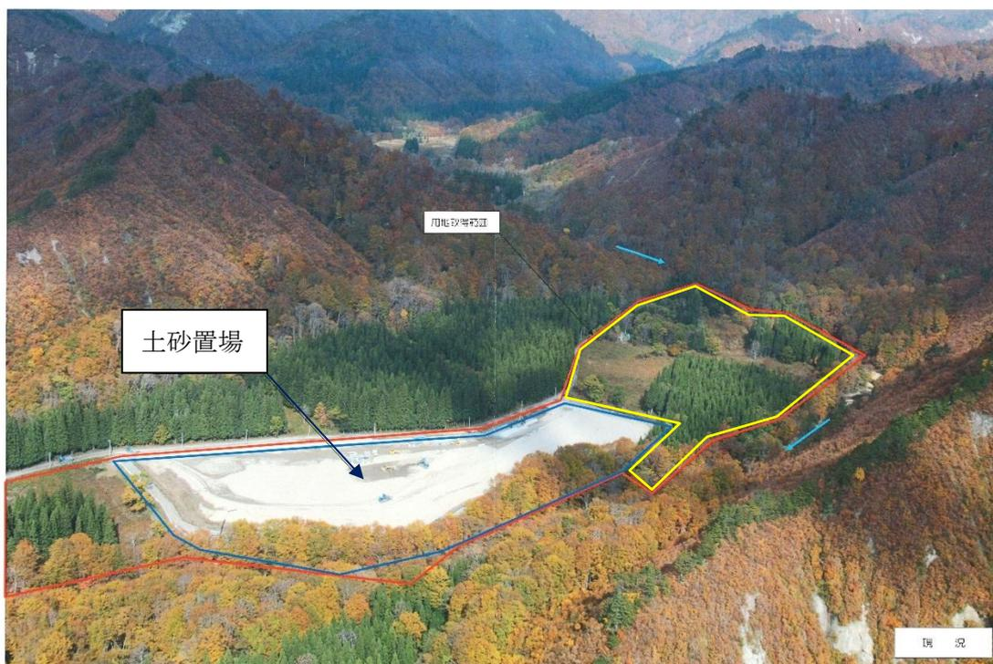
図 4-4 Tadami BR 北西部の蒲生川流域の浚渫土砂置場概況（青線内：既造成済み土砂置場面積、40,0290 m<sup>2</sup>、黄線内：2023 年より新規造成予定地、56,647 m<sup>2</sup>）。さらに上流域、あるいは他流域の土砂置場造成も検討されている。
